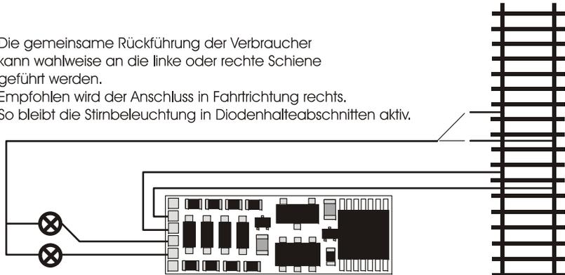
Die gemeinsame Rückführung der Verbraucher ist an den Anschluss VS angeschlossen. Hierdurch liegt eine erhöhte Spannung an den Verbrauchern an und die Lampen leuchten heller.
